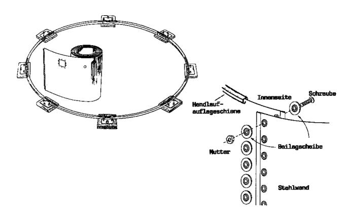
Stecken Sie den beigepackten Metallclip über die Stoßstelle der Stahlwandenden.
