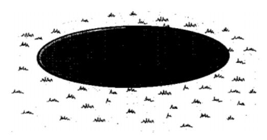
Da der hier entstehende Platz nicht glatt bzw. wasserwaageeben ist, muß dies mittels feinem Sand ausgeglichen werden.
