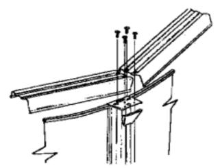
Wenn alle Handlaufschienen montiert sind, werden die großen Handlaufverbindungskappen mit den Gewindeschrauben verschraubt. Die kleine Handlaufverbindungskappe wird mit einer Blechschraube fixiert.
