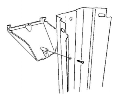
Jetzt stecken Sie jeden Steher in das Bodenschienenverbindungsstück bzw. Handlaufauflageplatte und verschrauben diese.
